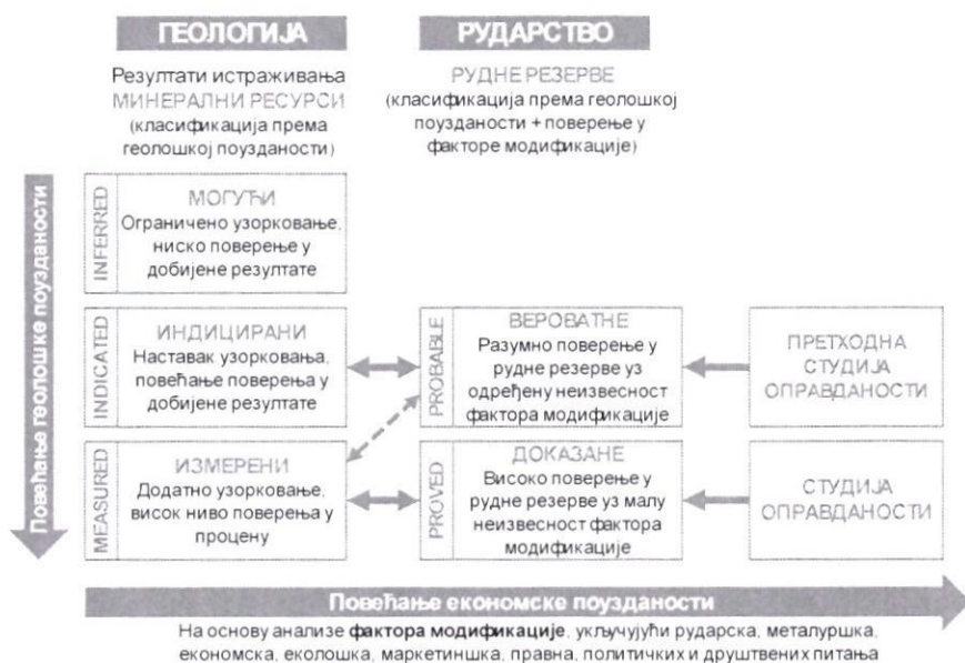
Слика 2.1. Општи однос између резултата истраживања, минералних ресурса и минералних резерви
